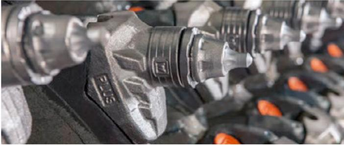
El sistema de portapicas **HT22** destaca por usar acero de alta resistencia al desgaste, así como por su mayor resistencia al desgaste y sus intervalos de sustitución significativamente prolongados. La parte superior rugosa se puede sustituir de forma rápida y sencilla directamente en la obra.
