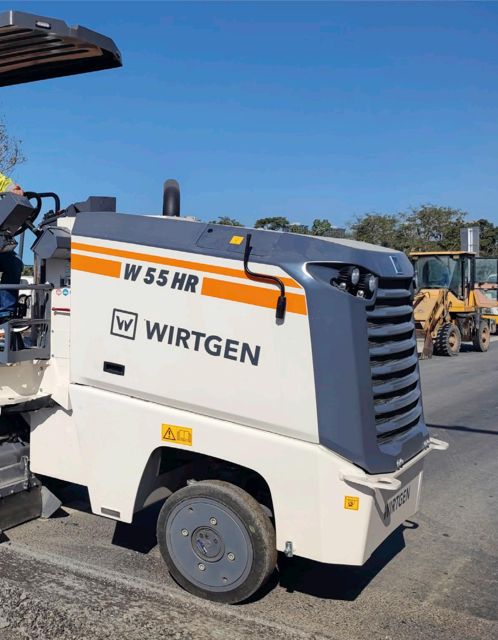
La fresadora en frío de medio metro extremadamente potente presenta un concepto operativo moderno y eficiente con una anchura de trabajo de 0,5 m. El moderno sistema de nivelación **LEVEL PRO PLUS** plenamente integrado en el control de la máquina garantiza unos resultados de fresado de alta precisión. La máquina se puede equipar con toda una serie de tambores de fresado diferentes, lo que incrementa su flexibilidad y utilidad.
