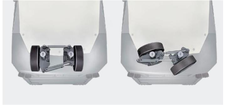
El eje delantero permite ángulos de dirección grandes.
