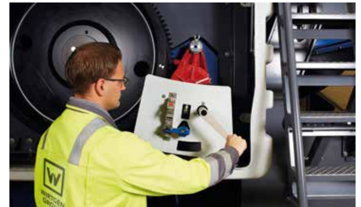
> Krank ile rotor güvenli bir şekilde döndürülür ve darbe plakasını değiştirmek için optimum konuma getirilir.
