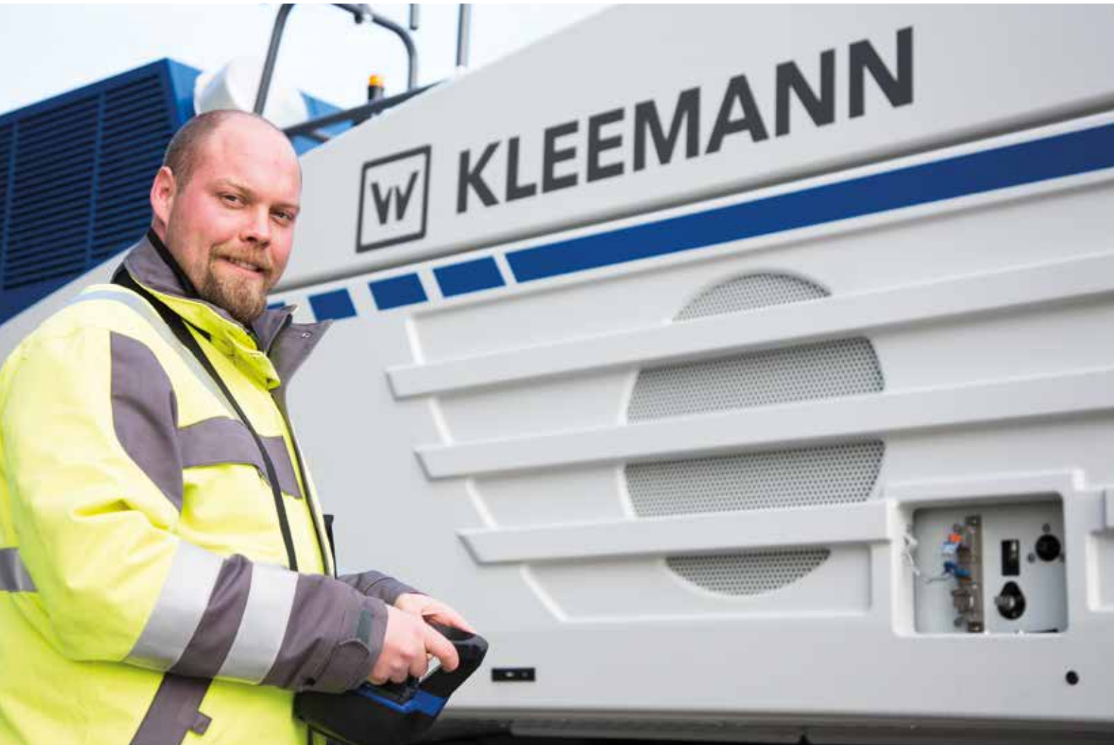
> Kumanda elemanı onay istasyonuna takılmalıdır; rotor güvenli şekilde kilitleilir ve anahtar diğer adımlar için serbest bırakılır.
