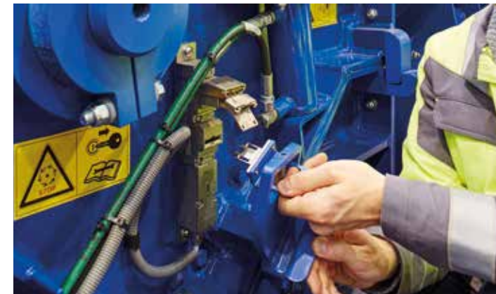
> Kırıcı muhafazası özel bir anahtarla açılır. Açıldıktan sonra anahtar çıkarılmaz ve malzeme güvenli bir şekilde temizlenebilir.
