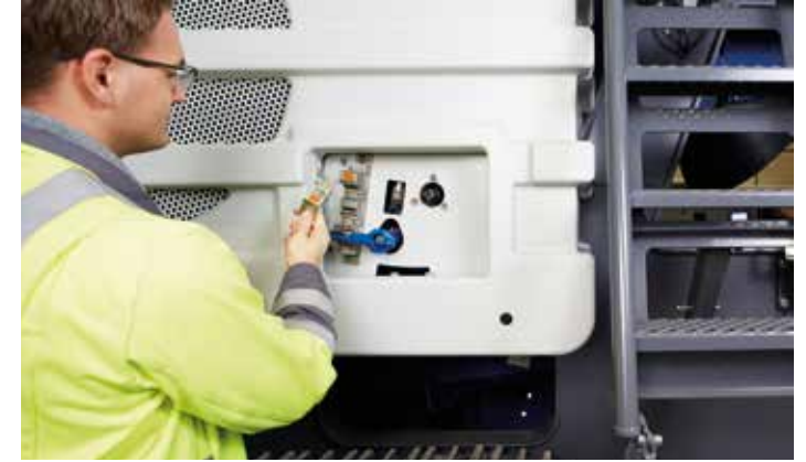
> Anahtarın çıkarılması halinde rotor güvenilir şekilde emniyette kalır.
