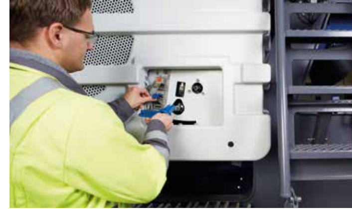
> Kumanda elemanı onay istasyonuna takılmalıdır; rotor güvenli şekilde kilitleilir ve anahtar diğer adımlar için serbest bırakılır.
