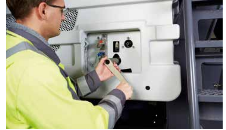
> Rotor kilitleme ve döndürme tertibatı onaylanmıştır ve bir krank ile hareket ettirilebilir.
