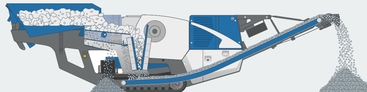
La instalación se caracteriza por un manejo sencillo e intuitivo, destaca con diferentes sistemas de regulación y sobrecarga y ofrece un funcionamiento especialmente potente y eficiente. El CFS, por ejemplo, facilita el trabajo del operador, ya que la máquina proporciona automáticamente un flujo de material uniforme y, por consiguiente, se encarga de la alimentación óptima de la machacadora. Además, el renovado diseño del alimentador vibrante garantiza un flujo del material mejorado.
