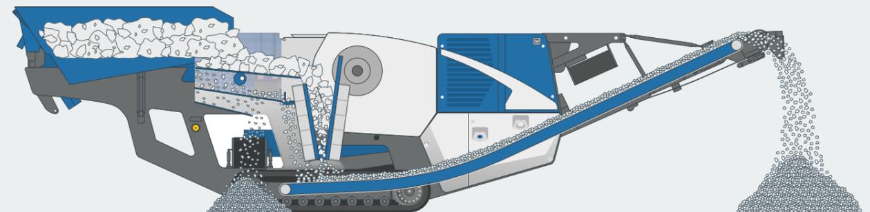
L'installation est facile et intuitive à utiliser, impressionne avec divers systèmes de régulation et de surcharge et est extrêmement puissante et efficace en fonctionnement. Le Continuous Feed System facilite par exemple le travail de l'opérateur, car la machine assure automatiquement un flux de matériaux régulier et donc un chargement optimal du broyeur. La conception améliorée de l'alimentateur assure aussi un flux de matériaux encore meilleur.
