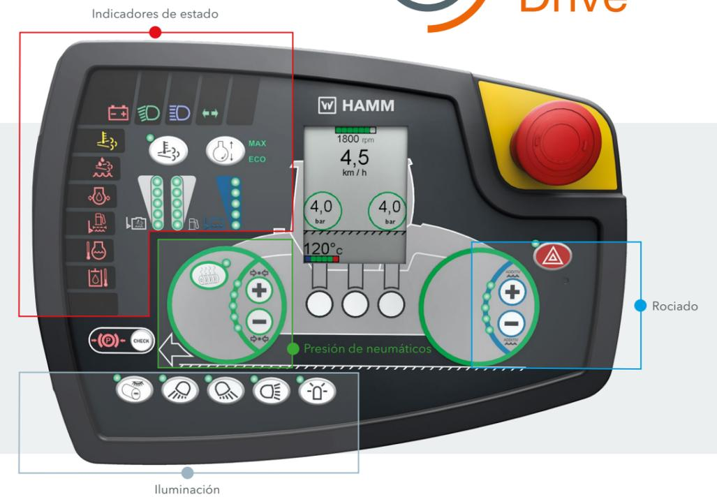
Tablero de instrumentos de las máquinas con Easy Drive (EPA Tier 4/EU nivel V)
