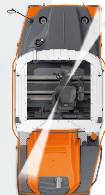
Si el conductor va sentado en el lado derecho o izquierdo de la plataforma y mira de lado más allá del capó del motor o del depósito de agua, siempre tiene a la vista los flancos de las ruedas exteriores.
