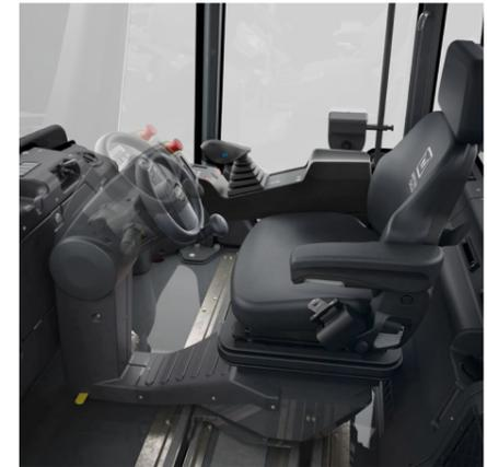
Se puede ajustar individualmente el ángulo de inclinación del tablero de instrumentos y del volante.
