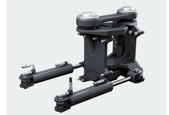
Das 3-Punkt-Pendelknickgelenk sorgt für exzellente Fahrstabilität und dämpft Stöße wirkungsvoll.
