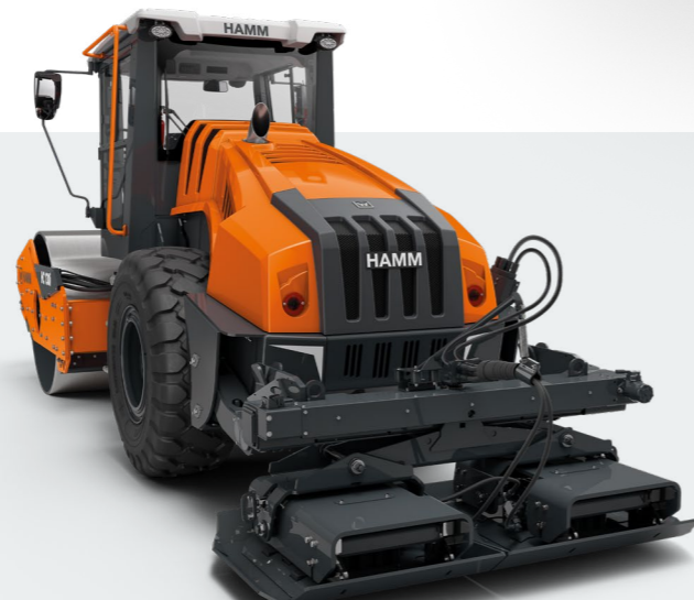
Der Anbau-Plattenverdichter kann seitlich verschoben werden. Das ermöglicht die Verdichtung auch in den kritischen Randbereichen.
