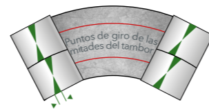
Las tensiones de cizallamiento se reducen un 50 % en la compactación con tambor dividido
