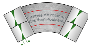
Réduction de 50 % des contraintes de cisaillement lors du compactage avec rouleau divisé
