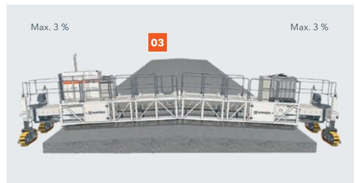
Vollautomatische Anpassung der Maschine an das Fahrbahnprofil.
