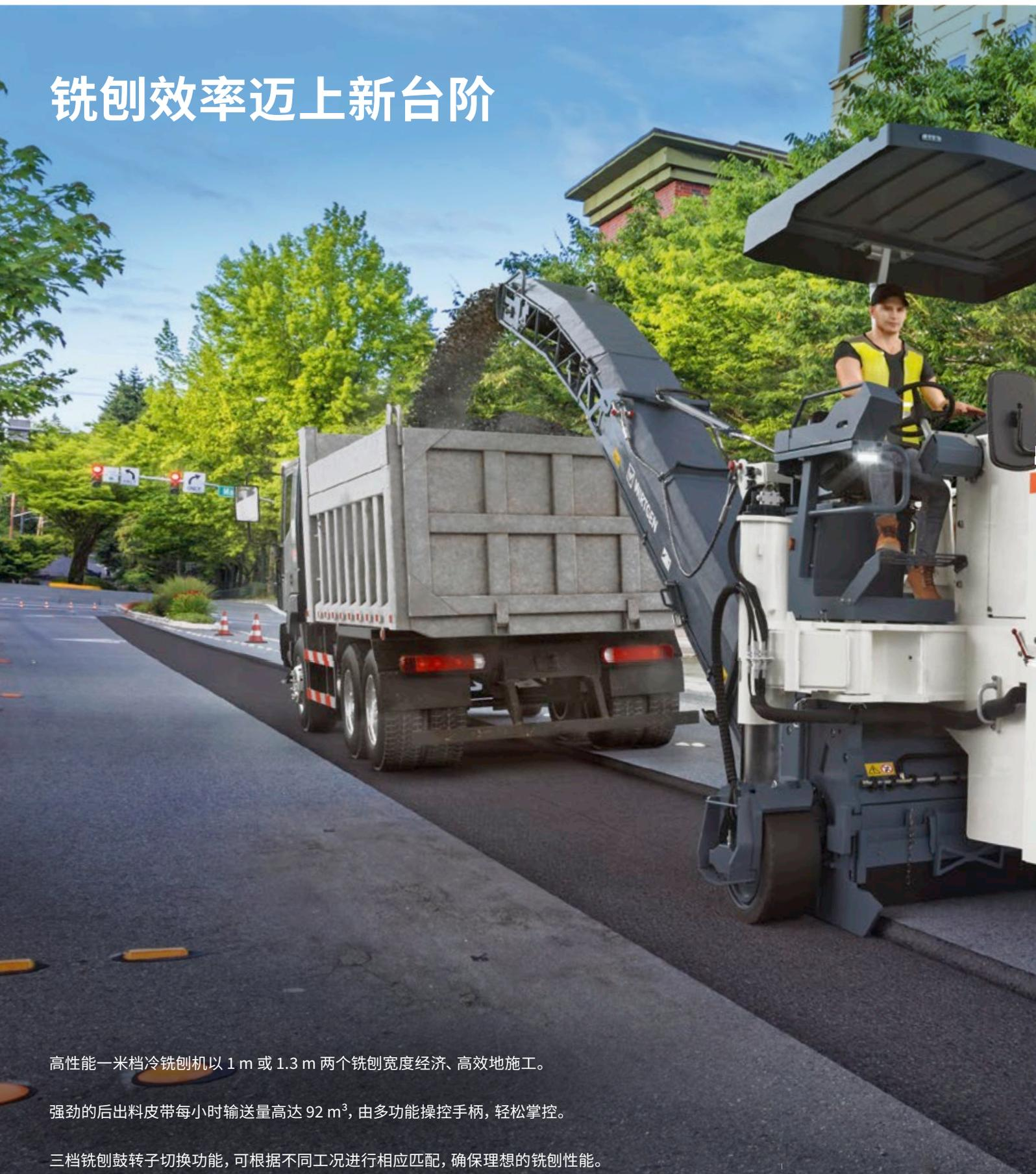
高性能一米档冷铣刨机以 1 m 或 1.3 m 两个铣刨宽度经济、高效地施工。
