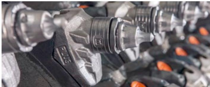
HT22 快换刀座系统的主要特性是采用高耐磨钢, 增强了耐磨性, 延长了保养间隔时间。坚固的上刀座在施工现场即可轻松拆卸。
