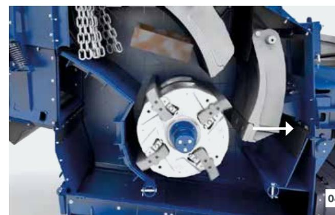
01 Geometría de la machacadora 02 Barrones 03 Sistema de ajuste 04 Sistema de sobrecarga
