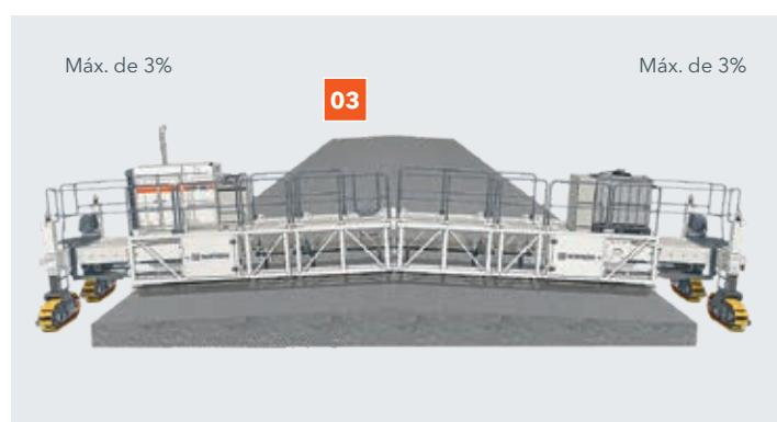
Adaptação totalmente automática da máquina ao perfil da superfície da estrada.
