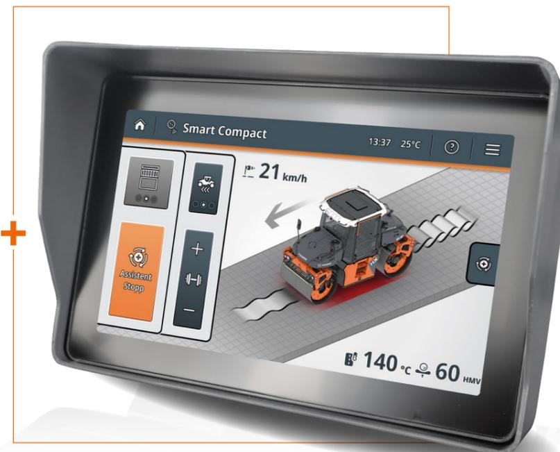
L'entrée et la sortie des données se font via le Smart Display supplémentaire sur le tableau de bord. Le conducteur y voit la couche actuellement compactée, le sens de la marche, la vitesse du vent, la température de l'enrobé, la valeur de compactage (HMV) et les paramètres de compactage actuels pour chaque cylindre.
