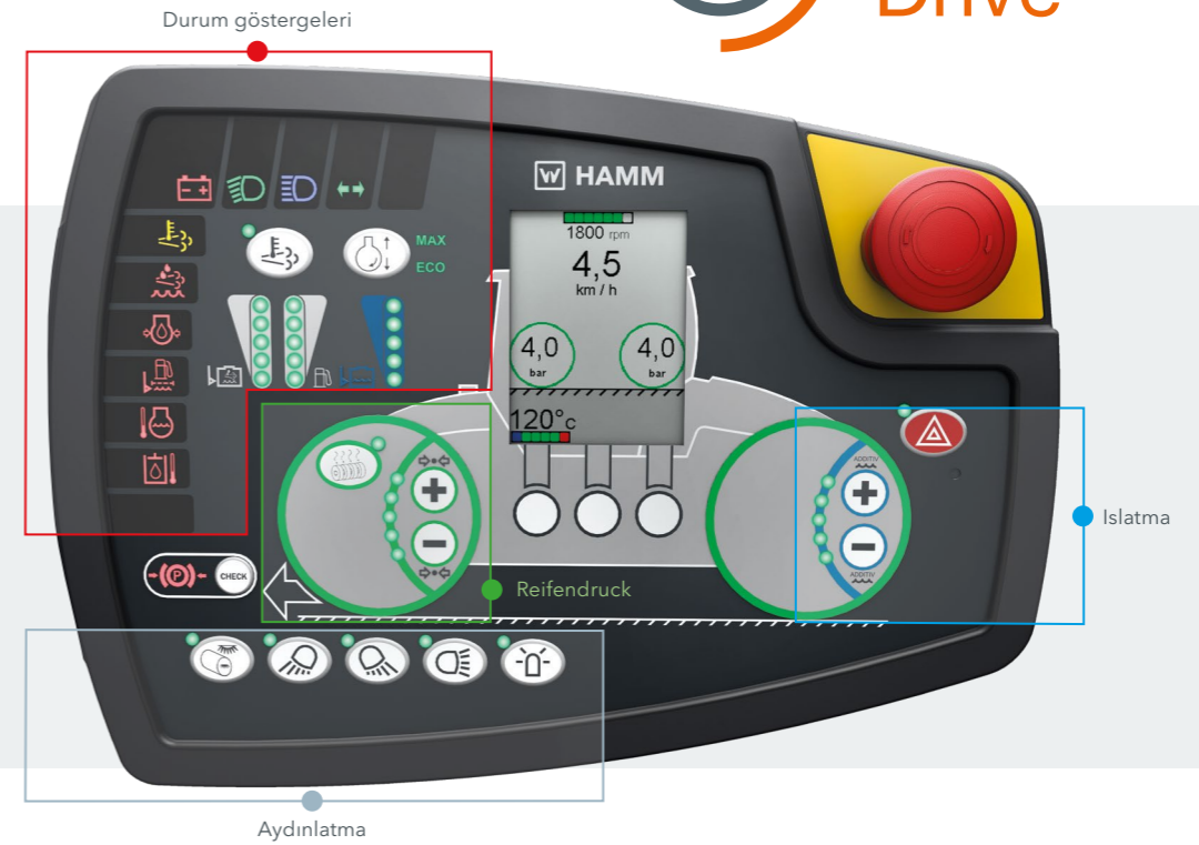
"Easy Drive" özelliği olan makinelerin gösterge ve kumanda tablosu (EPA Tier 4/AB Kademe V)
