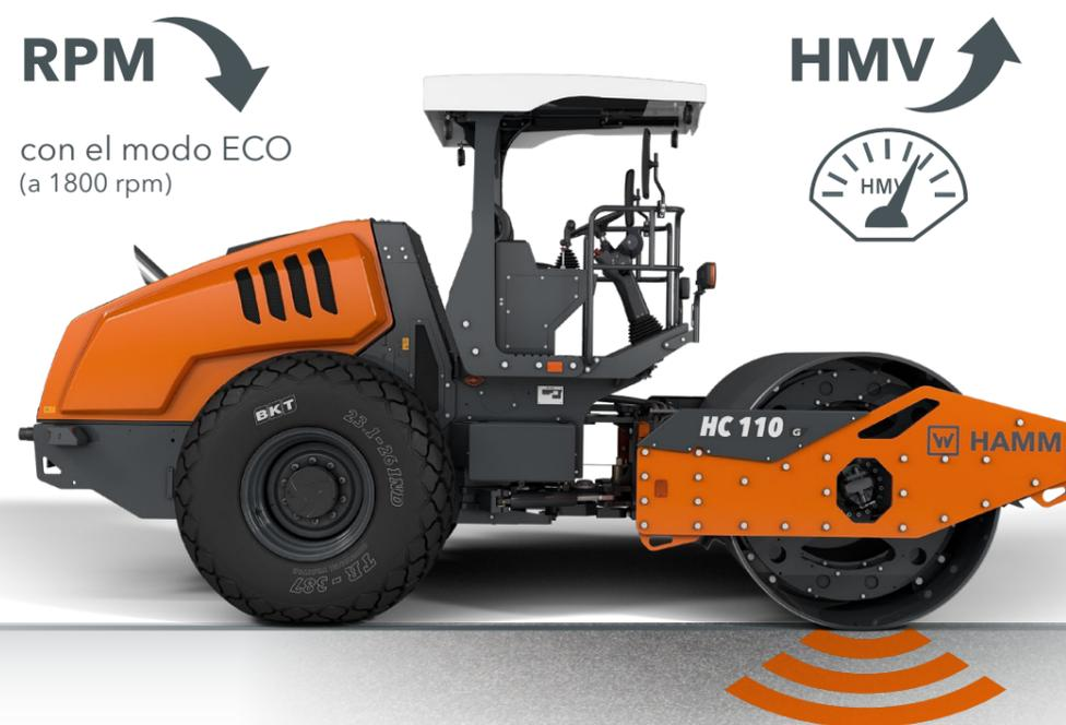
En el modo ECO, los compactadores trabajan a una velocidad reducida de 1.800 rpm. La potencia de compactación se mantiene constantemente alta.
