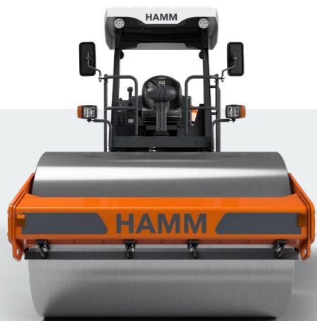
Toit de protection
