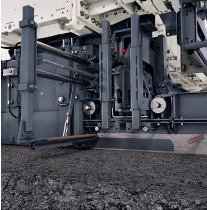
Insertador de barras de anclaje laterales por separado.
