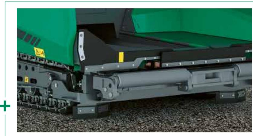
Los rodillos de empuje para camiones, muy anchos y montados en suspensión oscilante permiten una alimentación cómoda y sin sacudidas por parte de los vehículos transportadores de la mezcla incluso en curvas. Los rodillos de empuje pueden colocarse por completo en dirección longitudinal y adaptarse así a la geometría del camión de la mezcla.
