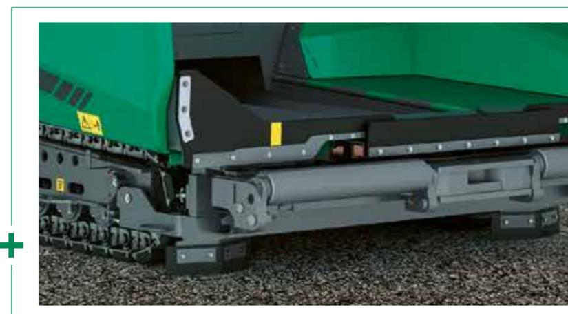
I rulli respingenti a sospensione oscillante elastica particolarmente larghi dell'autocarro di rifornimento del materiale permettono di alimentare comodamente e senza scossoni anche in curva. I rulli respingenti possono essere regolati completamente in direzione longitudinale per adattarsi alla geometria dell'autocarro di approvvigionamento.
