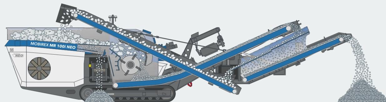
L'MR 100(i) NEO/NEOe è caratterizzato da un'ottima qualità. Ciò è reso possibile non solo dalla potente unità di frantumazione, dotata di un rotore a 4 martelli con un grande campo d'azione, e dalla possibilità di montare diverse varianti di martelli, ma anche dalla grande unità di vagliatura secondaria a un piano da 4 m<sup>2</sup> (equip. a richiesta). Quindi è possibile produrre pezzature finali di qualità classificata. Grazie al ricircolo integrato dei residui
