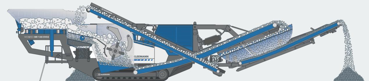
Flusso di materiale ottimale: nel MOBIREX MR 130(i) EVO2 le larghezze di sistema sono state aumentate in tutto l'impianto nella direzione di scorrimento del materiale; in questo modo il flusso non subisce restringimenti e si previene la formazione di intasamenti. Grazie alla regolazione della fessura di frantumazione, completamente
