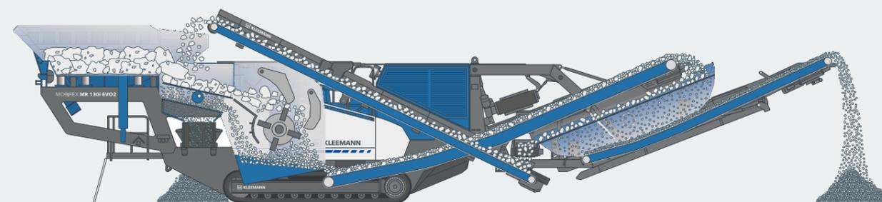
Fluxo de material ótimo garantido: as larguras do sistema da planta MOBIREX MR 130(i) EVO2 se alargam em toda a planta no sentido do fluxo do material fazendo com que o fluxo de material não seja estreitado e seja evitado, com eficácia, acúmulos de material. O ajuste totalmente hidráulico da abertura de britagem permite
