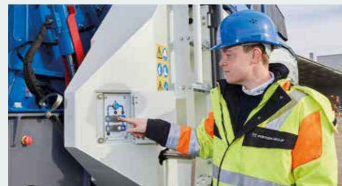
> La trituradora se desbloquea pulsando un botón...
