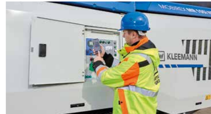
1. Conexión de MR 100(i) NEO con SPECTIVE CONNECT simplemente escaneando los datos de acceso de la pantalla de la máquina.
