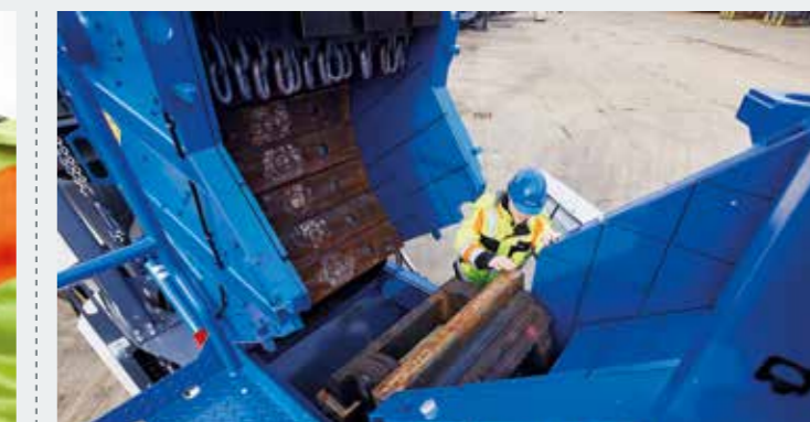
> La trituradora está completamente abierta, para una mejor accesibilidad para el servicio técnico y el mantenimiento desde ambos lados. El cambio de los barrones se lleva a cabo desde arriba fácilmente.
