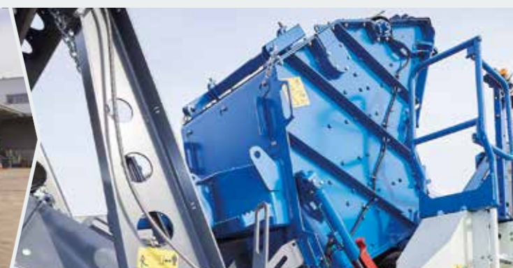
... hasta que la trituradora se abre por completo. El seguro mecánico encastra adicionalmente.
