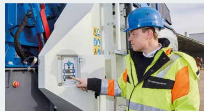
> Apertura automática del alojamiento de la trituradora cuando el botón se mantiene presionado...
