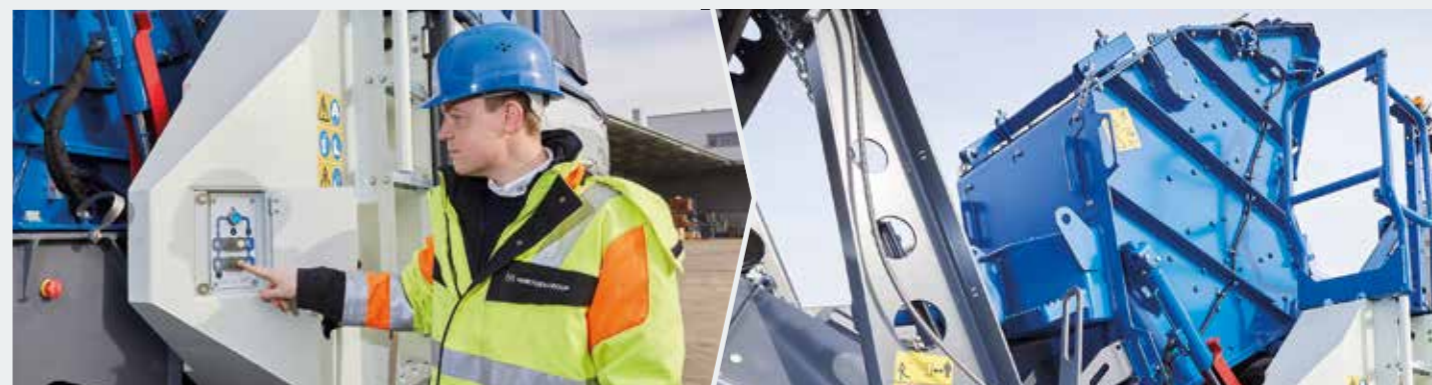
> Ouverture automatique du bâti du broyeur en maintenant le bouton enfoncé...
