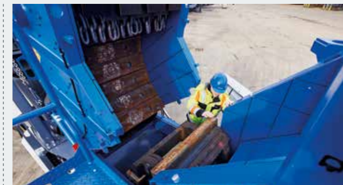
> Le broyeur est complètement ouvert afin d'assurer un accès optimal pour le service et la maintenance des deux côtés. Le remplacement des battoirs s'effectue simplement par le haut.
