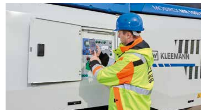
1. Raccordement du MR 100(i) NEO avec SPECTIVE CONNECT en scannant simplement les données d'accès depuis l'écran de la machine.
