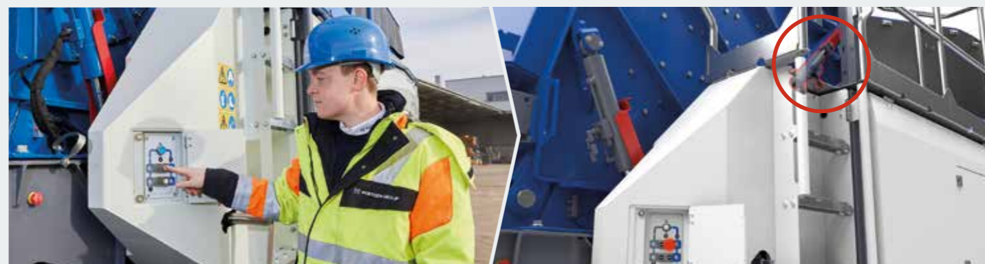
> Le broyeur est déverrouillé par pression d'un bouton...
