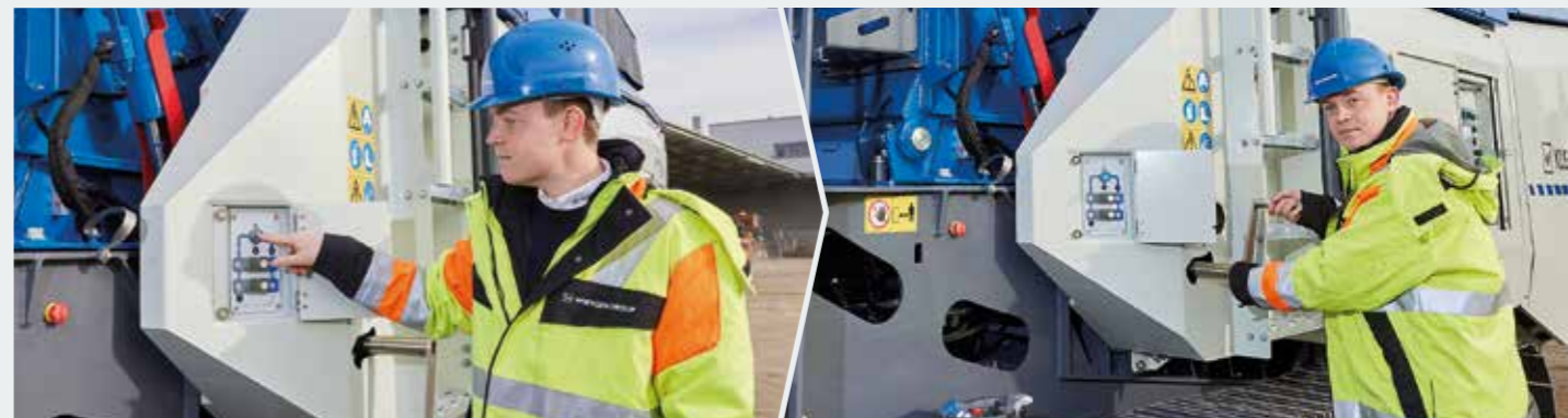
> En pressant un bouton, le déblocage du dispositif de blocage et de rotation du rotor est demandé...
