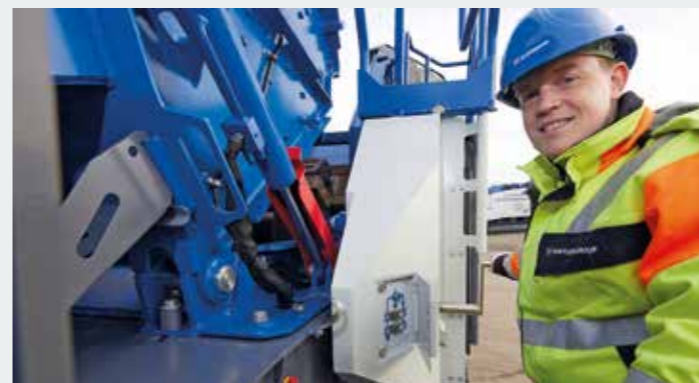
> Le rotor est amené en position pour le contrôle d'usure ou le remplacement des battoirs.
