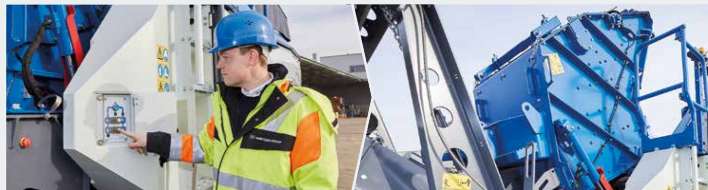
> Apertura automatica dell'alloggiamento del frantoio tenendo premuto un pulsante...
