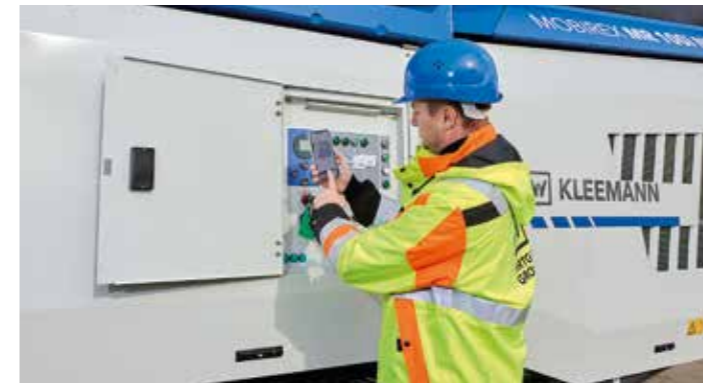
1. L'MR 100(i) NEO viene collegato a SPECTIVE CONNECT mediante la semplice scansione dei dati di accesso dal display della macchina.
