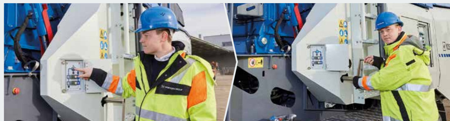
> Il dispositivo di bloccaggio e rotazione del rotore si sblocca premendo un pulsante...
