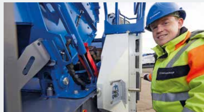
> Il rotore viene portato in posizione per il controllo dell'usura o per la sostituzione dei martelli.
