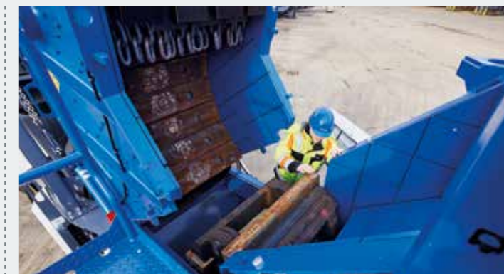
> Il frantoio è completamente aperto, per garantire la migliore accessibilità per l'assistenza e la manutenzione da entrambi i lati. I martelli vengono facilmente sostituiti dall'alto.
