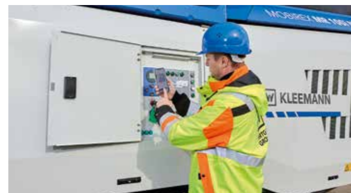
1. Połączenie kruszarki MR 100(i) NEO z systemem SPECTIVE CONNECT poprzez proste zeskanowanie danych dostępu z ekranu maszyny.
