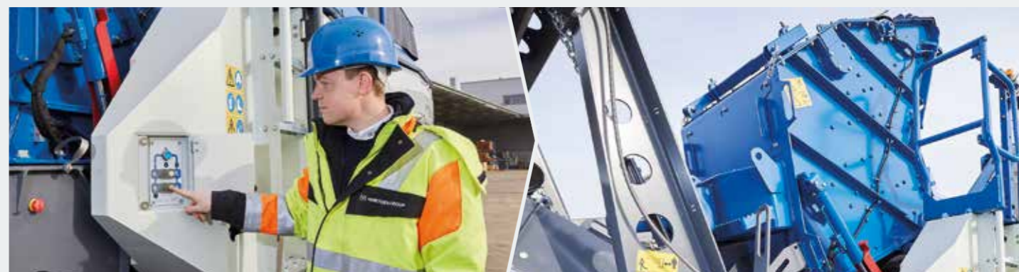
> Abertura automática da carcaça do britador mantendo o botão pressionado...
