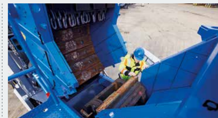
> O britador está completamente aberto de ambos os lados para permitir a melhor acessibilidade para assistência técnica e manutenção. A substituição da travessa de impacto é feita de forma simples a partir de cima.
