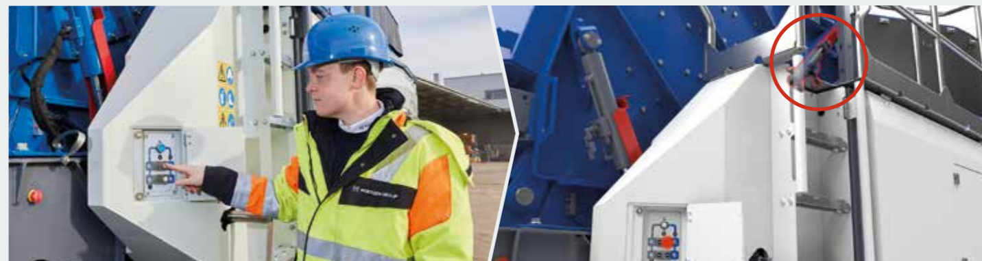
> o britador é desbloqueado por acionamento de botão...
