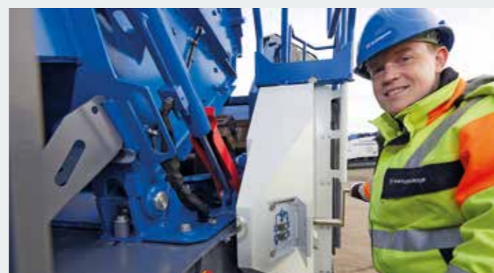
> O rotor é colocado em posição para controle do desgaste ou substituição das travessas de impacto.
