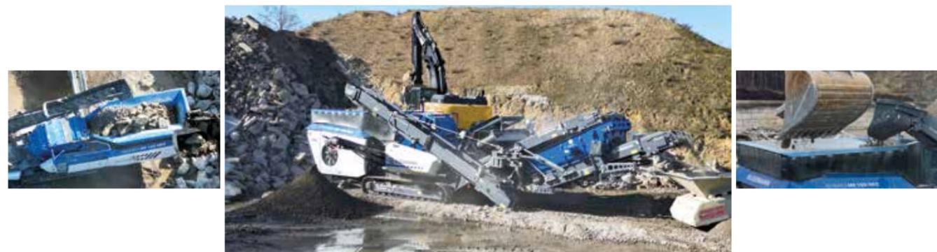
Боковой разгрузочный конвейер, смонтированный на правой стороне, складывается/раскладывается с помощью гидропривода, благодаря чему может оставаться на машине во время транспортировки.
