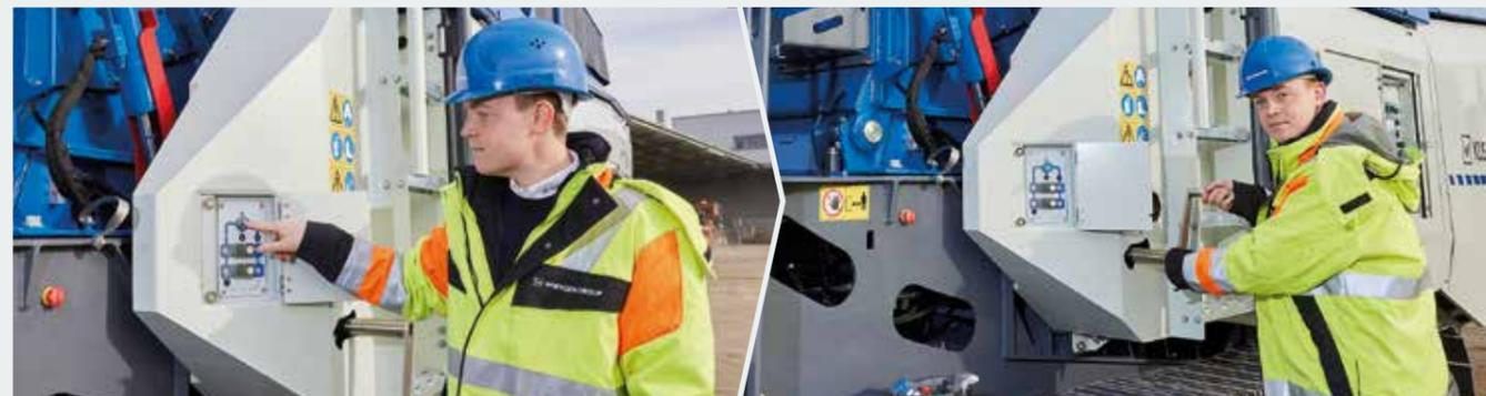
> Нажатием кнопки выполняется разблокировка устройства для блокировки и проворачивания ротора...
