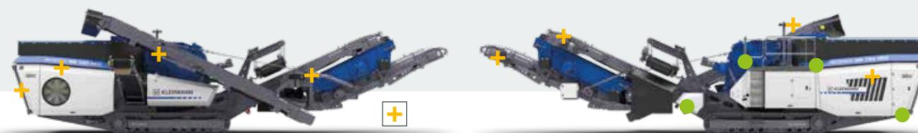
● Стандартное освещение + Освещение Premium □ Мобильная лампа для технического обслуживания
