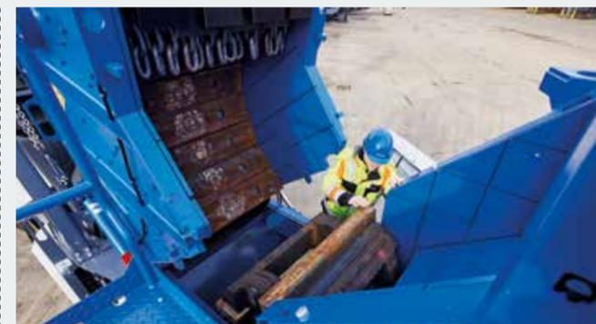
> Дробилка полностью открыта для доступа с обеих сторон для выполнения работ по сервисному и техническому обслуживанию. Замена бил выполняется сверху без каких-либо проблем.
