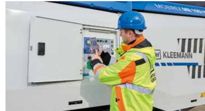
1. Синхронизация MR 100(i) NEO со SPECTIVE CONNECT происходит путём обычного сканирования данных доступа на дисплее установки.
