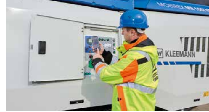
1. Makine ekranından erişim verilerini tarayarak MR 100(i) NEO'yu SPECTIVE CONNECT ile bağlayın.
