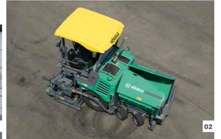
01 有限的功能元件,不需要显示屏。 02 中心转向功能,使外侧转弯半径减小到仅 3.8 m。
