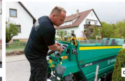
01 Мини-укладчики превосходно подходят для укладки асфальта между рельсами либо в полосы после фрезерования. 02 На стройплощадке мало места? Машины MINI - то, что вам надо.
