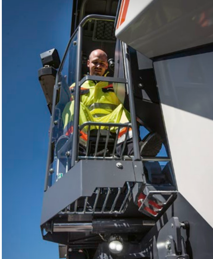
重要な作業エリアをすべて完全に把握できる、移動可能なオペレータスタンド
