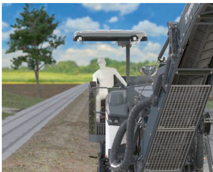
垂直方向と水平方向に調節可能なウェザーキャノピは、特にスペースが限られた現場など、さまざまな作業姿勢で最適な保護を提供します。
