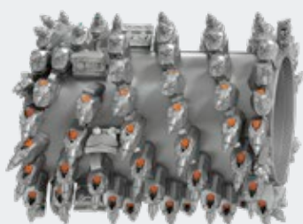
標準切削ドラム 切削幅: 1,200 mm 切削深さ: 0 ~ 280 mm 切削ビット間隔: 15 mm
