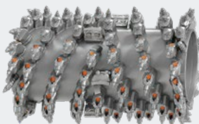
標準切削ドラム 切削幅: 1,500 mm 切削深さ: 0 ~ 330 mm 切削ビット間隔: 15 mm
