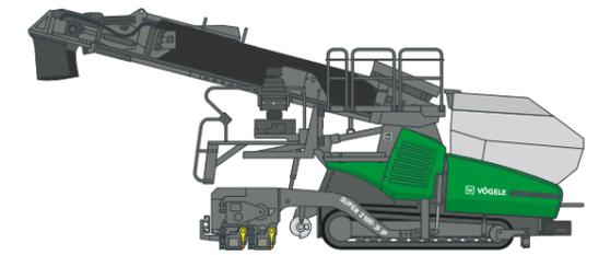
**SUPER 2100-3i IP Binderschichtfertiger für InLine Pave**
