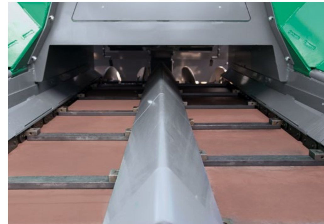
El protector estrecho de la cinta transportadora en la tolva receptora garantiza un flujo de mezcla uniforme.
