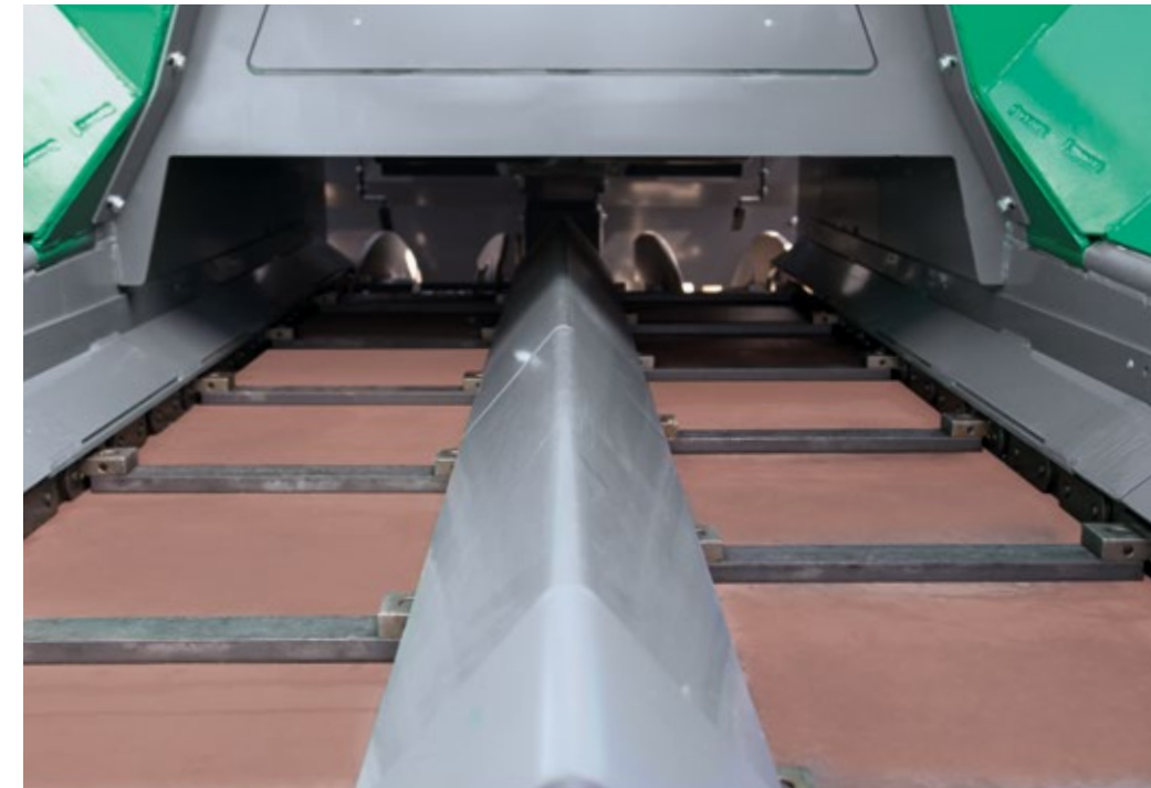
El protector estrecho de la cinta transportadora en la tolva receptora garantiza un flujo de mezcla uniforme.
