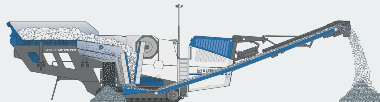
La MOBICAT MC 120(i) PRO cuenta con una unidad de alimentación de grandes dimensiones gracias a la cual se pueden alimentar grandes cantidades de material sin problemas con una excavadora o una pala cargadora. El elevado rendimiento de la instalación se observa también en las dimensiones de la boca de la machacadora y en el diseño extralargo de la mandíbula trituradora
