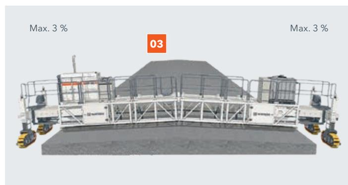
Adaptation entièrement automatique de la machine au profil de la chaussée
