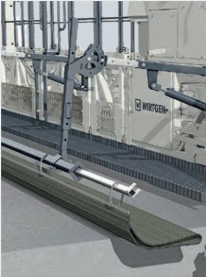
Fixation pour gazon artificiel ou toile de jute
