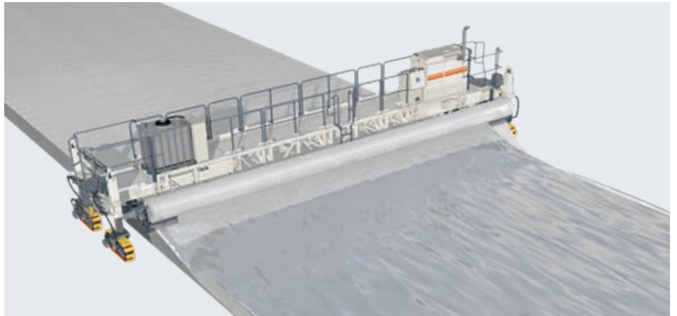
Dispositivo para el enrollado y desenrollado de láminas para proteger el hormigón de la lluvia.
