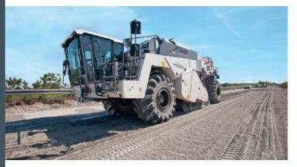
Der WR 240 überzeugt durch profil- und lagegerechten Einbau, denn die automatische Querneigungsregelung verhindert Materialverschiebung auf dem bereits erstellten Planum. Das Mischkonzept, bei dem Walzengehäuse und Rotor perfekt aufeinander abgestimmt sind, schafft perfekte Mischungen in kurzer Zeit, so dass der WR 240 mit hohem Vorschub stabilisiert.
