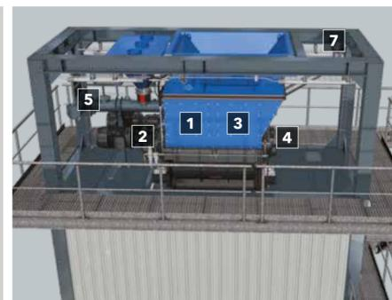
Toutes les demandes d'équipement ultérieur peuvent être fixées par système à bride sans problème à la section de pesage et de malaxage - nous retirons le couvercle de protection de fermeture de la bride, nous procédons au raccordement pour boulons - aucun soudage ni aucune modification de la structure est nécessaire.
