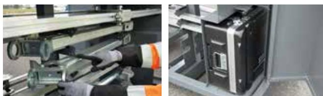
En la nueva caja de transporte estable se pueden guardar todas las piezas de forma segura y, gracias a su disposición lógica, están siempre a punto para el montaje.
