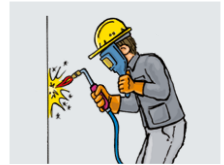
Vermeiden Sie das Hineinsehen in Schweißkabinen, insbesondere in den Lichtbogen von Schweißgeräten und Plasmaschneidanlagen.
