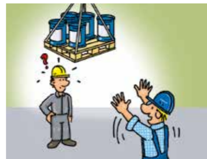
Nicht unter schwebende Lasten treten.
