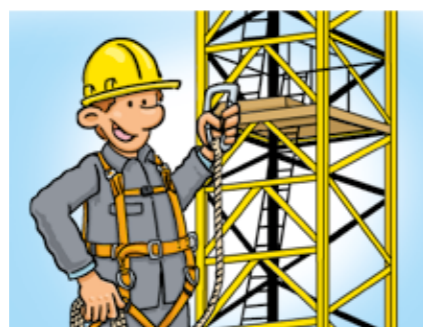
Bei hochgelegenen Arbeitsplätzen mit Absturzgefahr Sicherheitsausrüstung benutzen.
